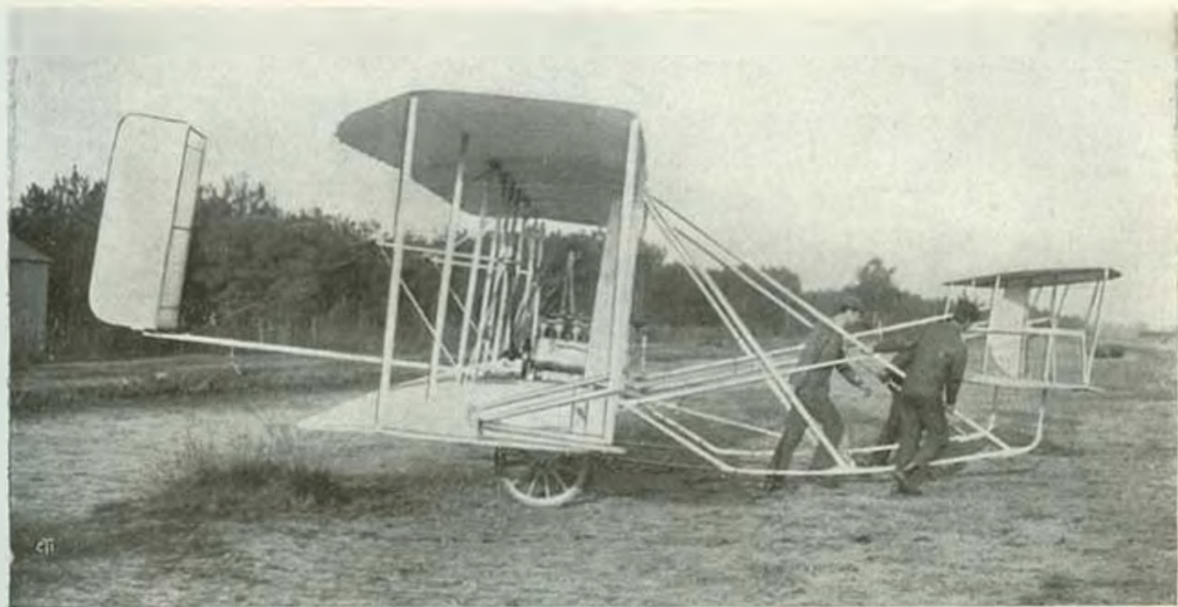
L'aeroplano è condotto, col sussidio di due ruote mobili, presso il pilone. Dinanzi il timone di elevazione: in centro la gran cellula cogli organi motori: dietro il timone di direzione.
