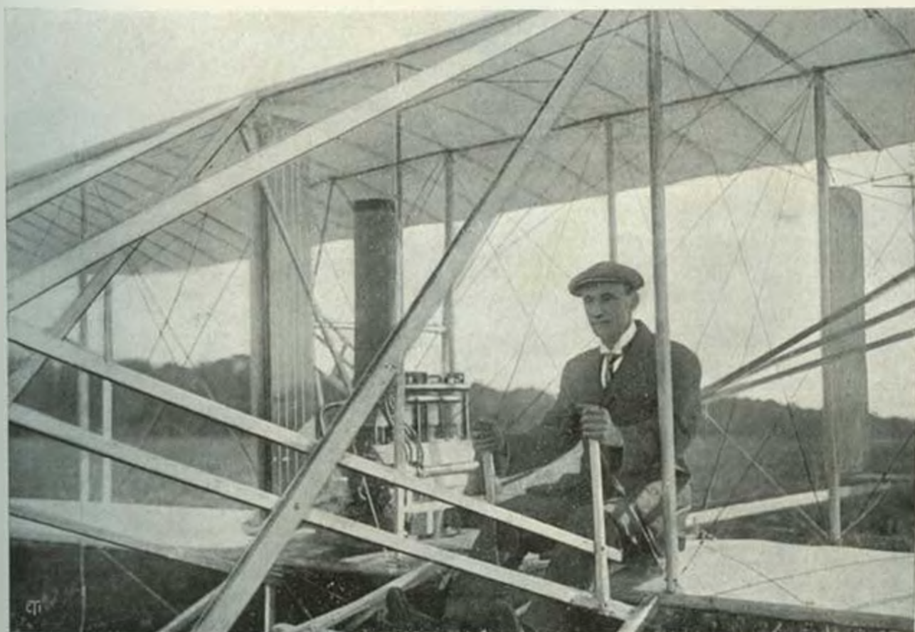
L'aviatore al comando delle due leve: a destra (di chi guarda) la leva del timone di elevazione (innalzamento e discesa); a sinistra quella del timone di direzione e del gauchissement delle ali. — In questa fotografia il serbatoio della benzina è verticale, mentre attualmente Wright gli ha dato la disposizione orizzontale (vedi sopra).
