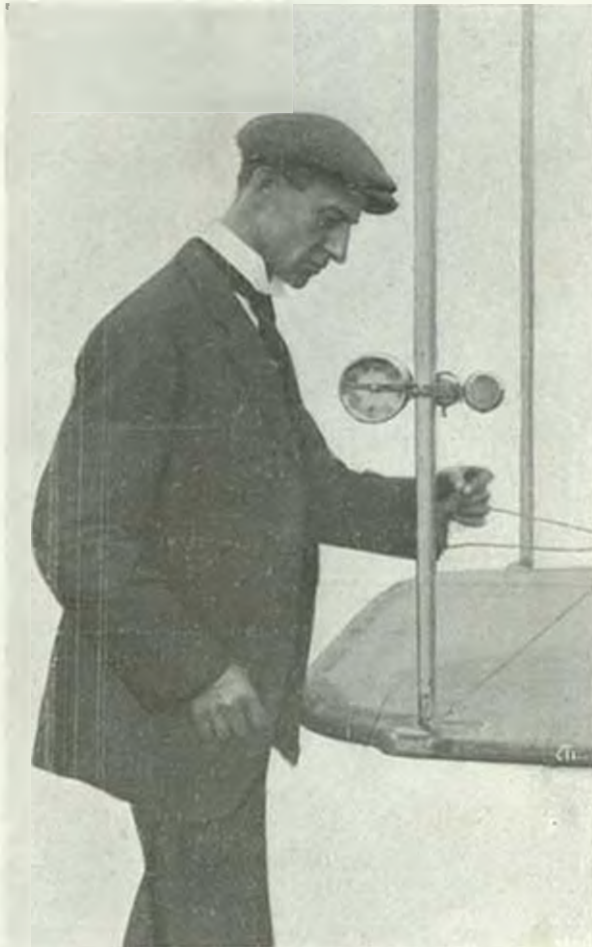
Wilbur Wright misura la velocità del vento con l'anemometro posto all'estremità della cellula centrale.
