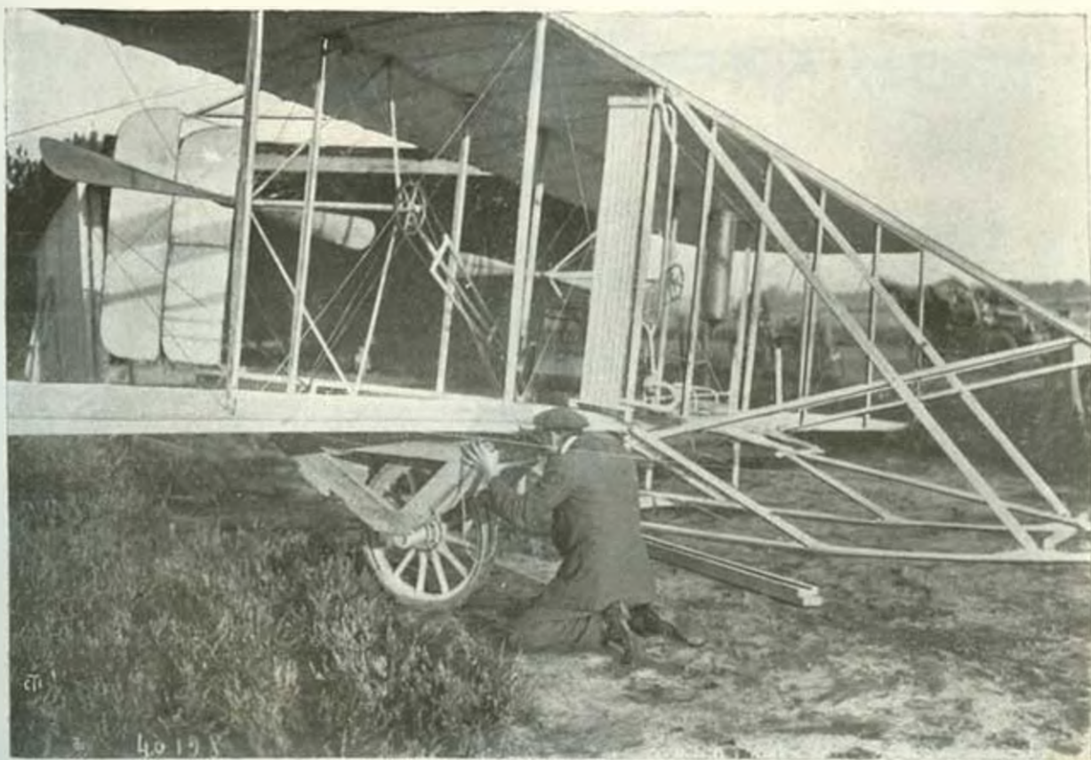
Quando l'aeroplano è discosto, Wright rimette le ruote per trascinarlo nuovamente al pilone — a tergo le due eliche innate; nel centro il radiatore verticale.
