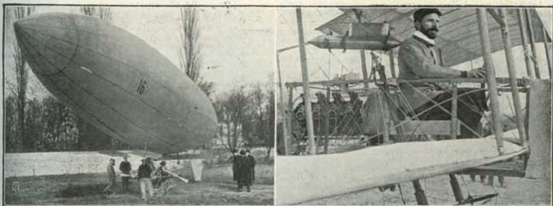
(a sinistra) Santos Dumont col suo nuovo dirigibile accoppiato con aeroplano a due motori. (a destra) Farman sul suo nuovo aeroplano N. 1 bis motore Renault 8 cil. col quale ha coperto 2 km. e 300 m. alla velocità di 60 km. l'ora.
