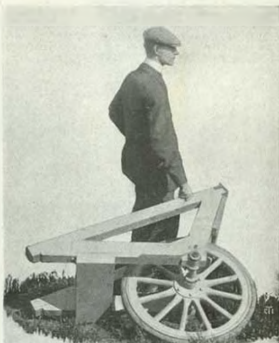
Una delle due ruote che servono alle dislocazioni per terra dell'aeroplano.
